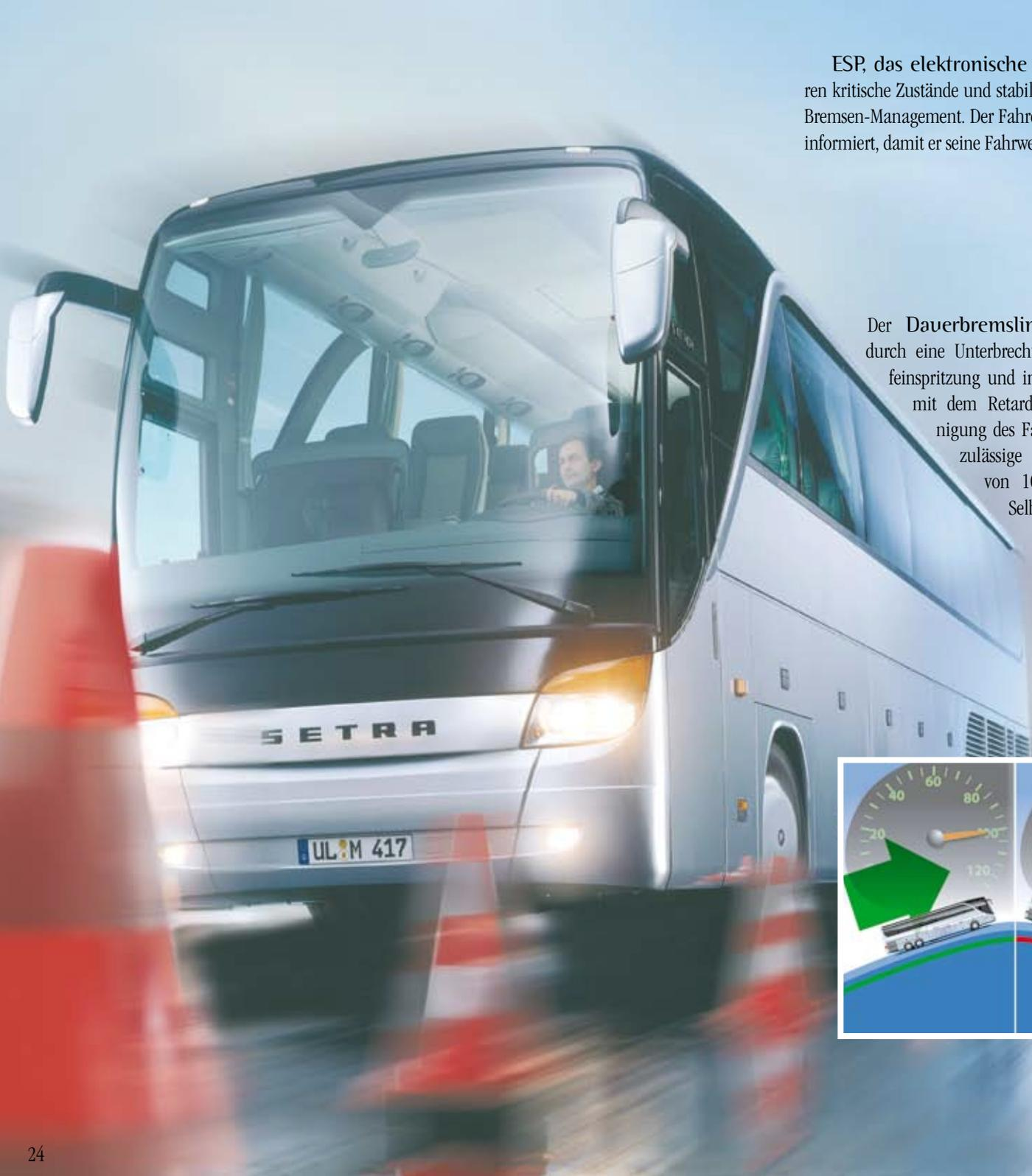
ESP, das elektronische Stabilitäts-Programm, erkennt über Sensoren kritische Zustände und stabilisiert das Fahrzeug durch gezieltes Motoren- und Bremsen-Management. Der Fahrer wird zeitgleich über das Multifunktions-Display informiert, damit er seine Fahrweise den Umständen anpassen kann.
